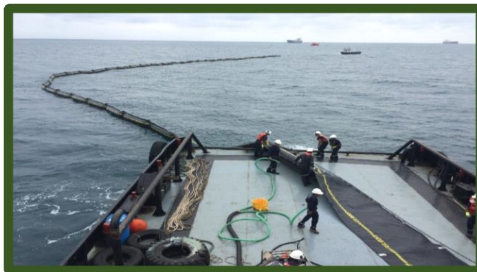
Despliegue de barreras flotantes R/AZUAY
