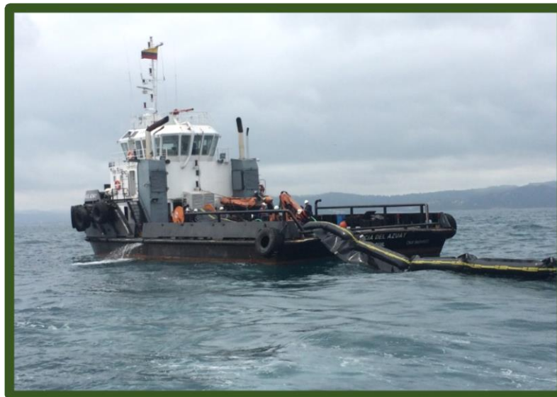
Inicio del despliegue de barreras flotantes a bordo del R/AZUAY
