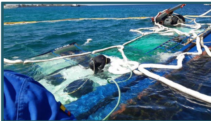
Barcaza “ORCA”, naufragada en el muelle “LA PREDIAL” de la Isla San Cristóbal, Galápagos. Material absorbente de control de contaminación ubicado en el lugar para absorber cualquier tipo de hidrocarburo que proceda de la embarcación.
