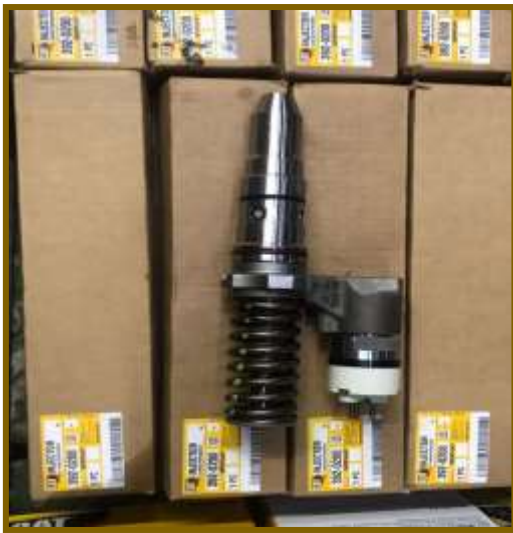
Cambio de inyectores de las 02 máquinas principales del remolcador Marte
