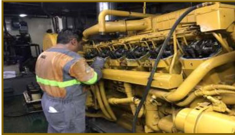
Reparación de máquinas principales del Remolcador Marte
