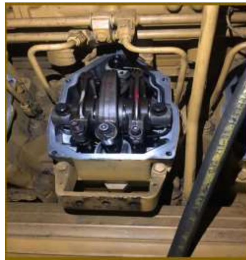
Cambio de inyectores de las 02 máquinas principales del remolcador Marte
